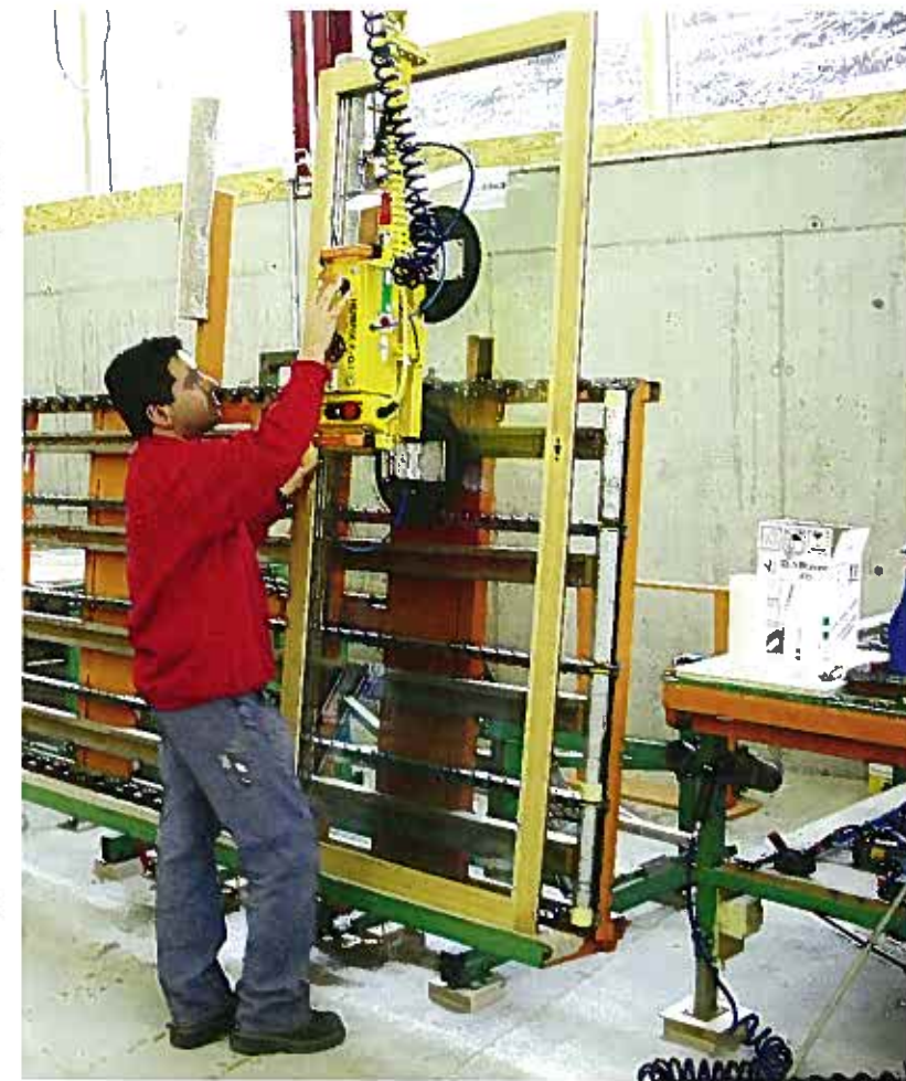
Rückenschonend: Glasbegegerät mit Vakuumsauger.
